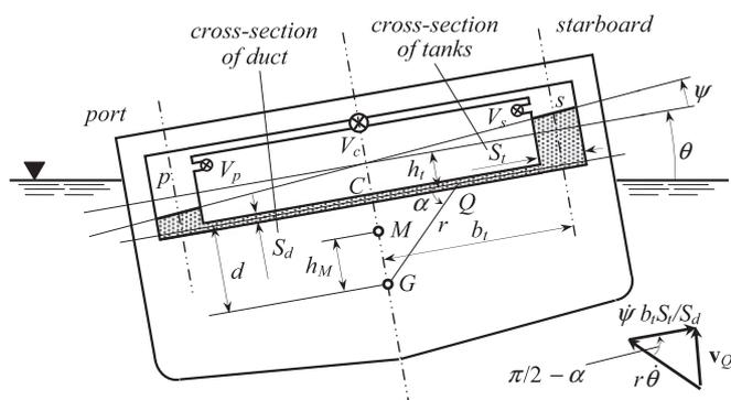
Fig. 1. Scheme of U-tank system ( $M$ : metacentre).
